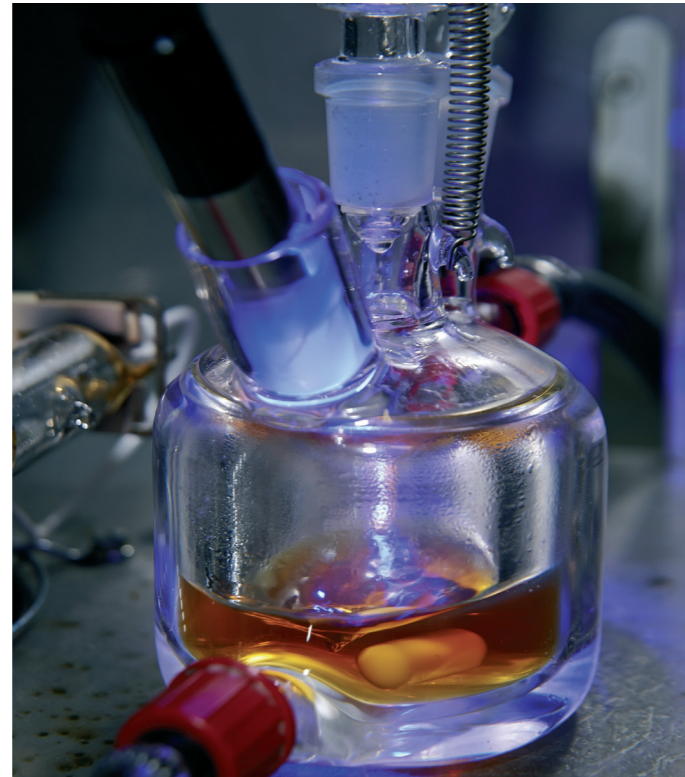
Photoreaktor im Labormaßstab: Die Kombination aus Lichteinstrahlung und dem richtigen Katalysator ermöglicht die Spaltung von Wasser in seine Bestandteile (Symbolbild)
