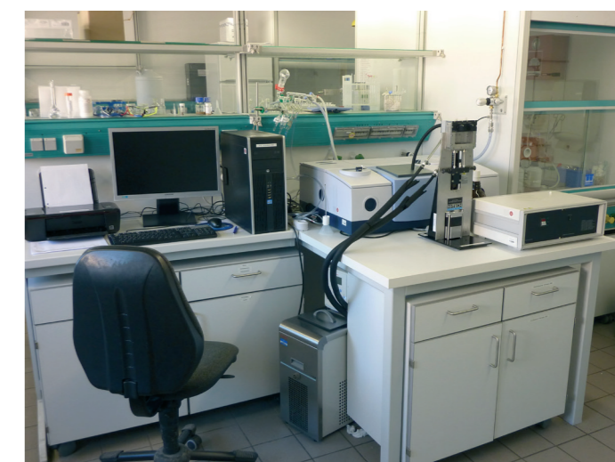
Abb. 1: Mit Hilfe des Bruker VERTEX 80 FTIR Spektrometer + Stopped-Flow-Einheit können rapid-scan-FTIR-Experimente durchgeführt werden. Ein gasgelagerter Scanner mit Geschwindigkeiten bis 320 kHz ermöglicht bei einer Auflösung von 2 cm -1 die Aufnahme von von IR-Spektren im Abstand von 100 ms. In Verbindung mit einer Stopped-Flow-Einheit können so Studien zur Kinetik homogener Reaktionen erfolgen. (R. Ludwig)
