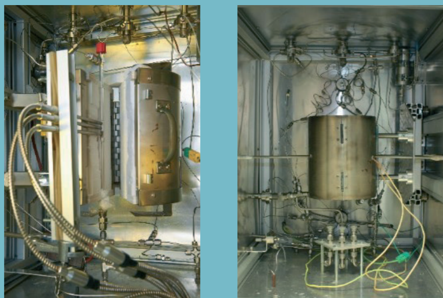
Abb.: Apparaturen zur ortsaufgelösten (links) und parallel zeitaufgelösten (rechts) Katalysatorcharakterisierung mittels UV-Vis-Spektroskopie unter industriell relevanten Bedingungen mit simultaner Analyse der Reaktionsprodukte. (Fotos: E. Kondratenko)
