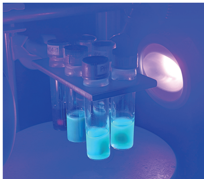
Abb. 1: Der Kupfer-Katalysator, der chemische Teil des künftigen Metalloenzym, wird getestet, und zwar in einer Lösung zyklischer Alkene. Die Reaktion startet unter UV-Licht. (Foto: LIKAT/P. Hünemörder)
