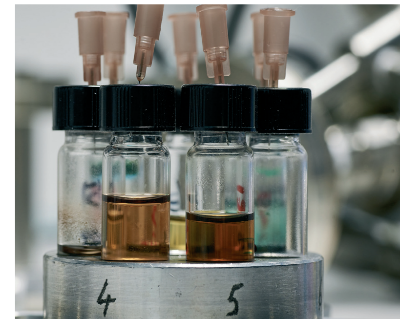
Abb. 2: Einsatz für Parallelreaktionen im Autoklav. (Foto: K. Junge/LIKAT)
